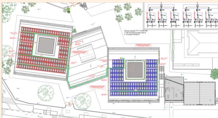
Impianto fotovoltaico sulla copertura
